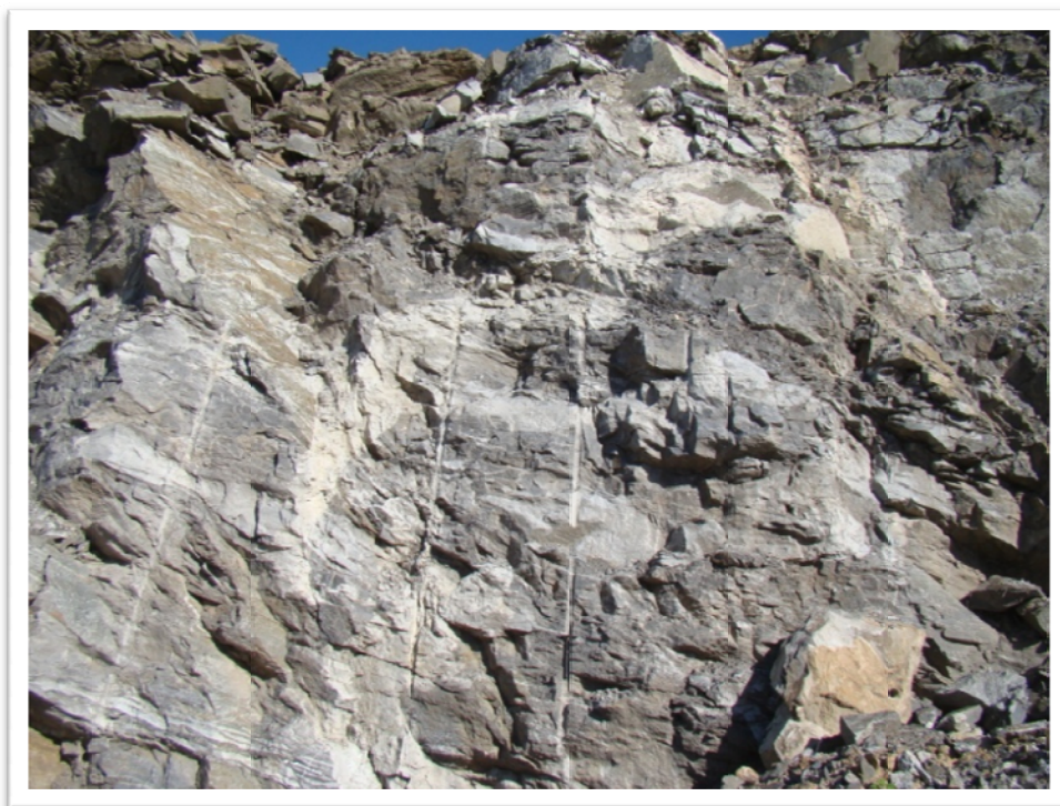
Foto 21: E 4008 LE – Taludes com inclinação variável de 76 a 80 graus exibem algumas meias canas preservadas.
