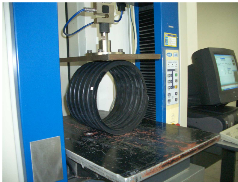
Foto 2: Ensaio de Resistência à Compressão
