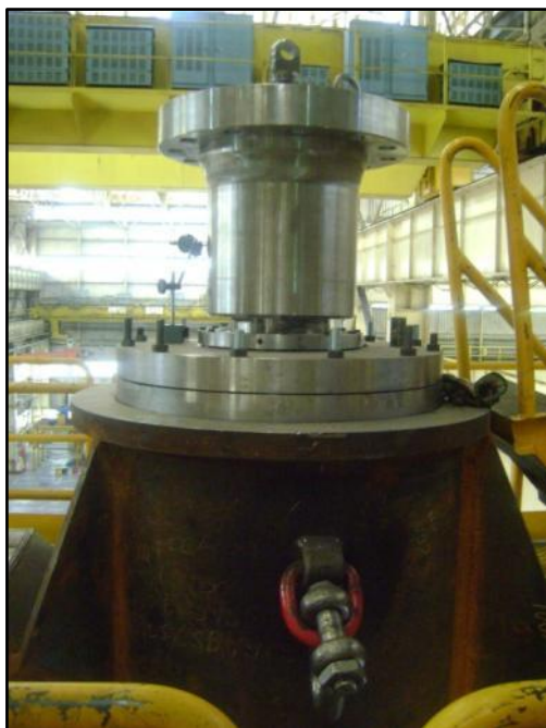
Montagem Acoplamento do Motor
