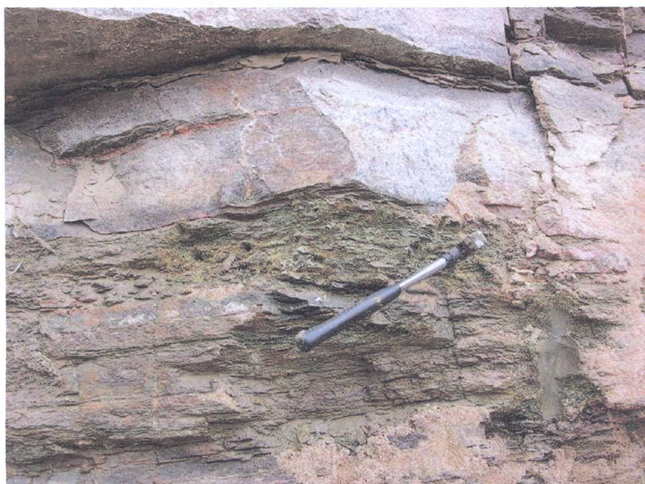
Foto 8 – Banda de biotita xisto. Cava dos pilares P7-P8.
