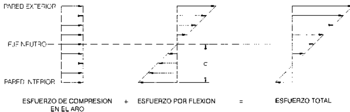
Figura 2: Distribución de esfuerzos en el perfil del tubo.
