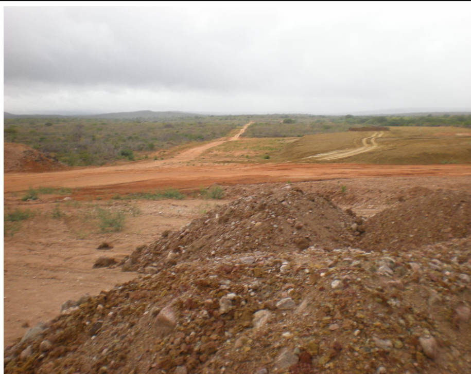
FIGURA 03 - Depósito de solo conglomerático ocorrente nas proximidades do eixo da barragem Mandantes. Nota-se que a quantidade de blocos, na sua grande maioria com diâmetro menor que 15 cm é bem inferior à matriz de solo.
