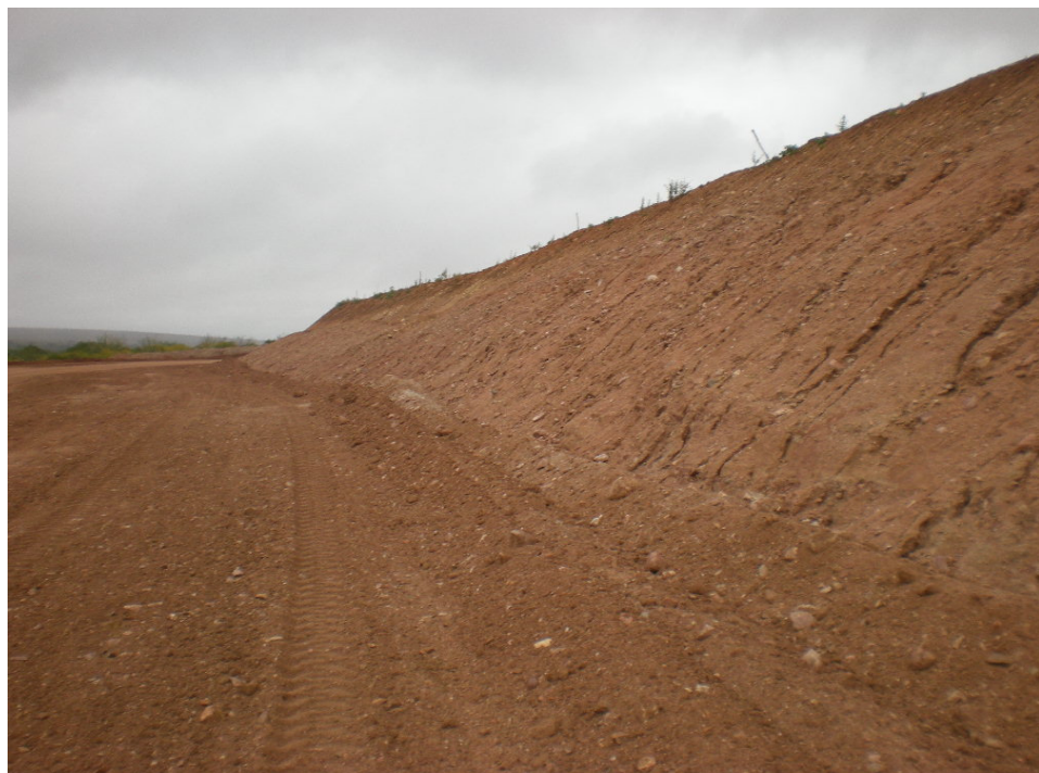
FIGURA 01 - Aspecto dos solos conglomeráticos ocorrentes nas proximidades da Barragem Mandantes. Note-se o grande percentual de matriz de solo em relação à baixa ocorrência dos blocos com diâmetro menor que 15 cm.
