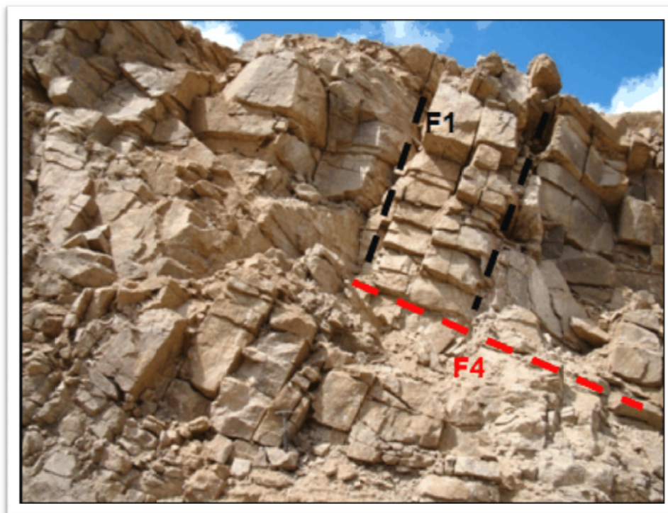
Foto 19: E 3979 LD – Fraturas F1= 80/70 , F4= 250/50 e F5= 340/80 que é a fratura que define o plano do talude.
