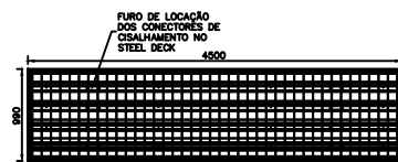
MÓDULO DO TABULEIRO (08x) ESCALA 1:25
