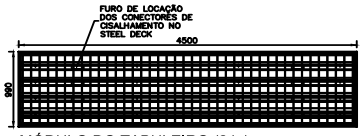
MÓDULO DO TABULEIRO (24x) ESCALA 1:20
