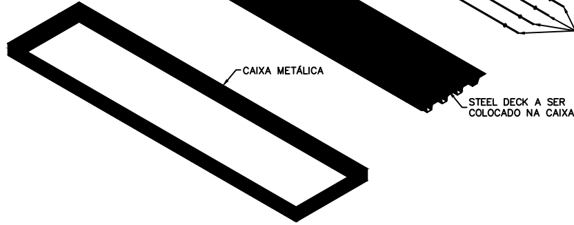
MONTAGEM MÓDULO TABULEIRO SEM ESCALA
