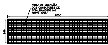
MÓDULO DO TABULEIRO (06x) ESCALA 1:25
