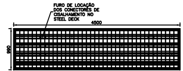
MÓDULO DO TABULEIRO (12x) ESCALA 1:20
