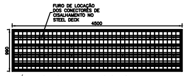
MÓDULO DO TABULEIRO (15x) / ESCALA 1:25
