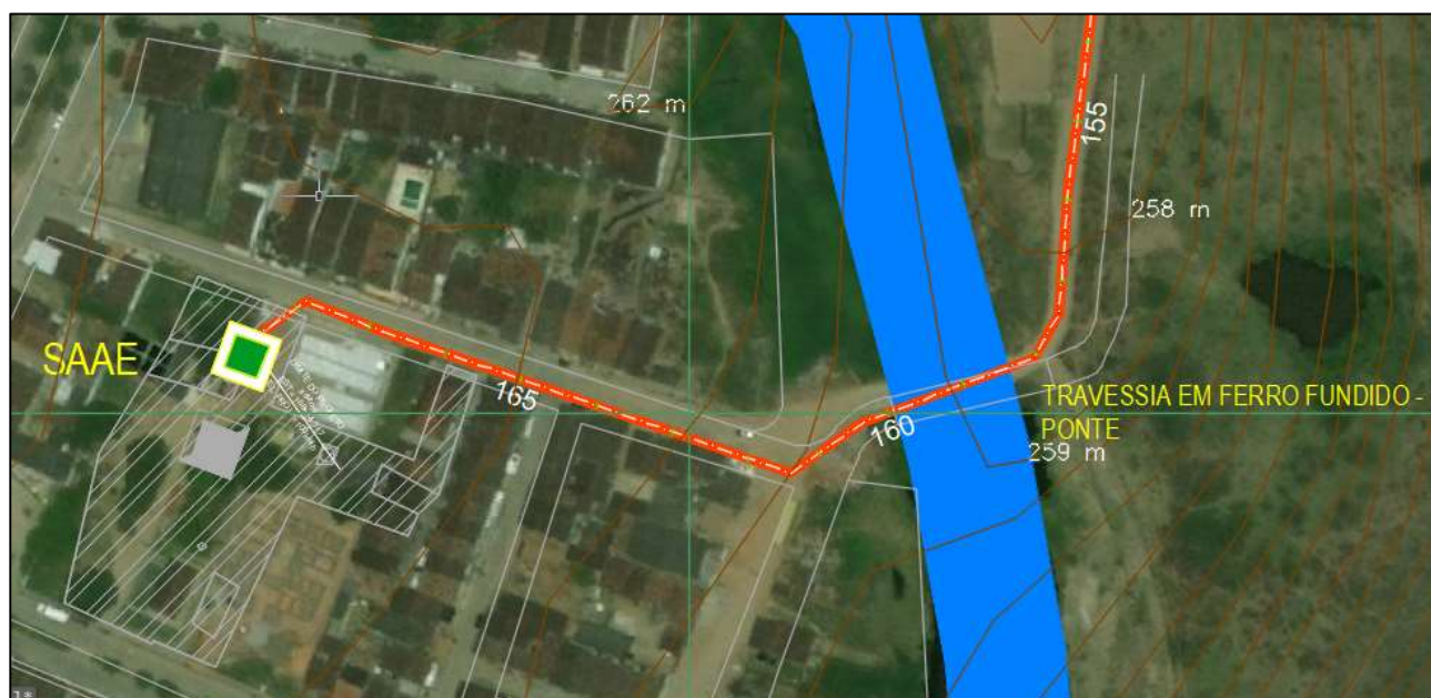
Figura 17 - Detalhes da Adutora: Chegada da Adutora no SAAE, Travessia da Adutora pela ponte.
