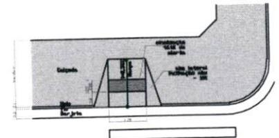
DETALHE RAMPA DE ACESSIBILIDADE (PNE - NBR 9059)
